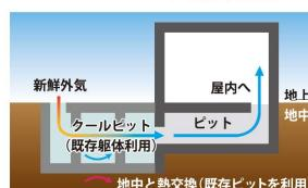
旧棟の地下船体を一部残して、外気に比べ安定した温度の地中の空气を新棟内に取り込み、空調負荷を低減
