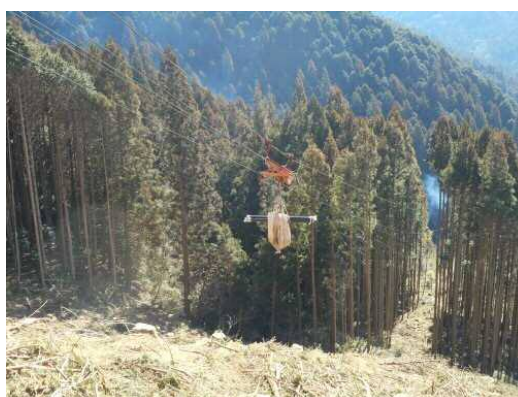
写真 2.8 架線による荷運び
