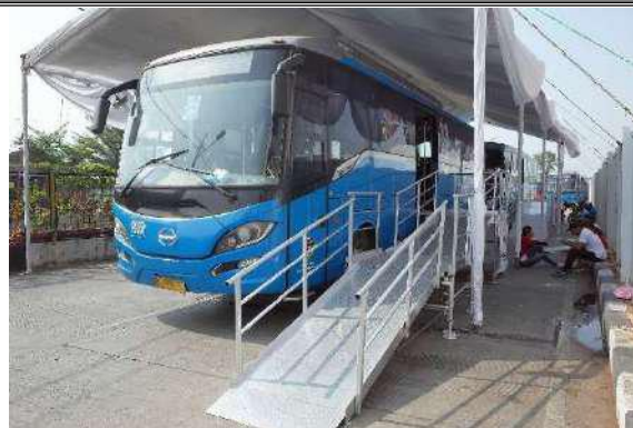
仮設スロープの例
