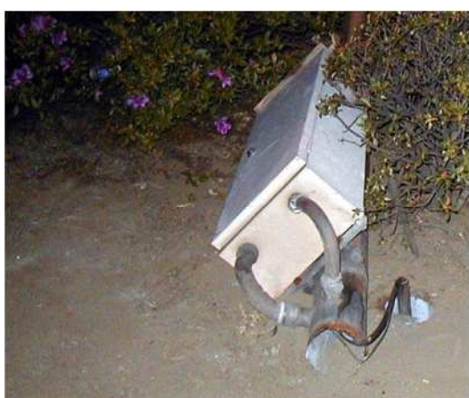
写真-2. 1 路面境界部の腐食が要因となった倒壊事例
