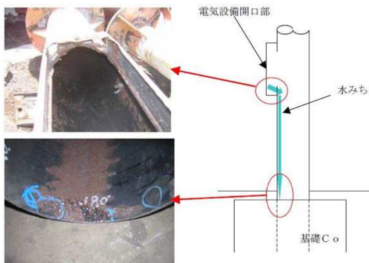
図-2. 1 電気設備用開口部からの雨水の浸入イメージ
