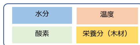
木材の腐朽に必要な4条件
