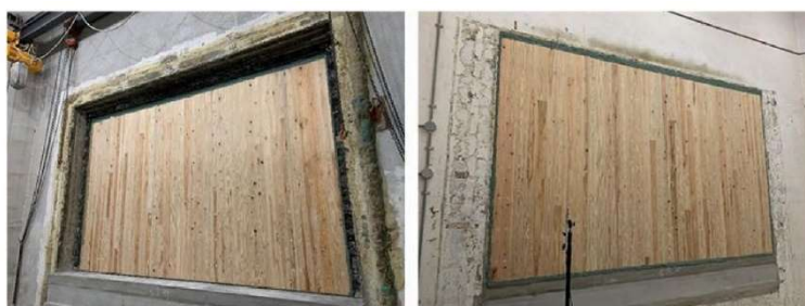
CLT を活用した間仕切壁の遮音性能試験状況
