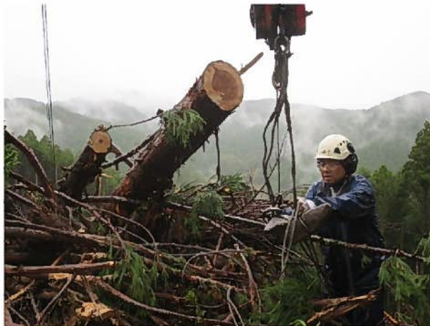
土場での荷外し 縛ったワイヤーが抜けずに苦勞する
