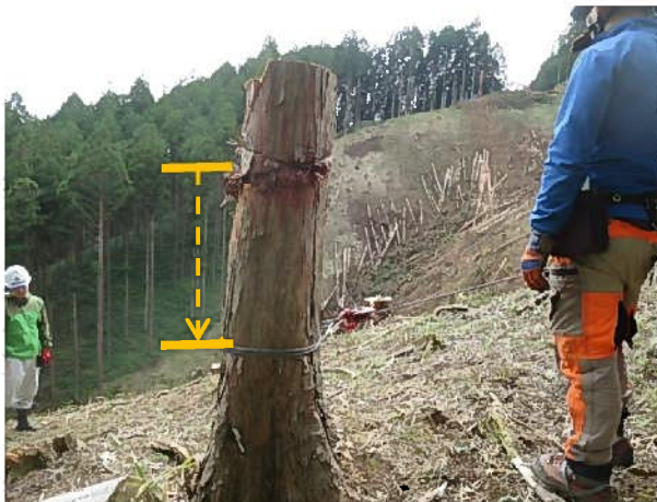
DRL 滑車取り付け木(サンド木)⑨ 角 滑車高さ 1m 程を低い位置へ付け直した
