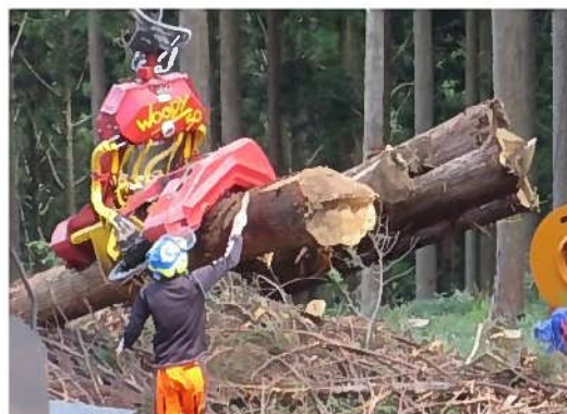
造材前に金属ブラシ等で丸太についた土砂を こすり落とす
