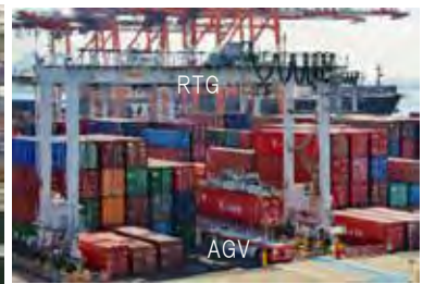
日本初の自動化コンテナターミナル（名古屋港飛島ふ頭南側コンテナターミナル） 自働搬送台車(AGV)と遠隔自働RTG
