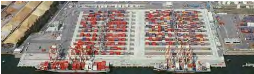
日本初の自動化コンテナターミナル（名古屋港飛島ふ頭南側コンテナターミナル） 自働搬送台車(AGV)と遠隔自働RTG
