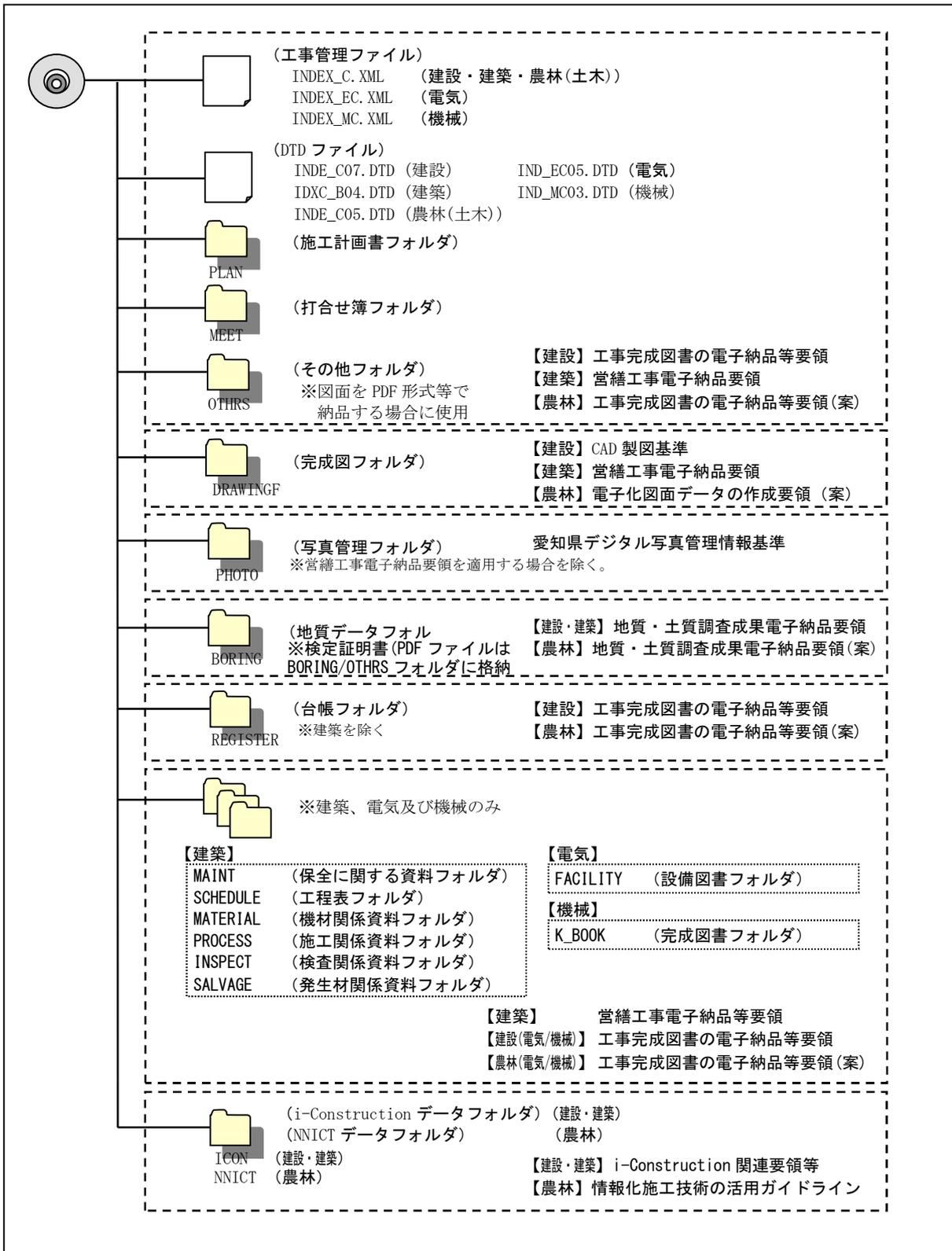
図-3 工事完成図書のフォルダ構成
