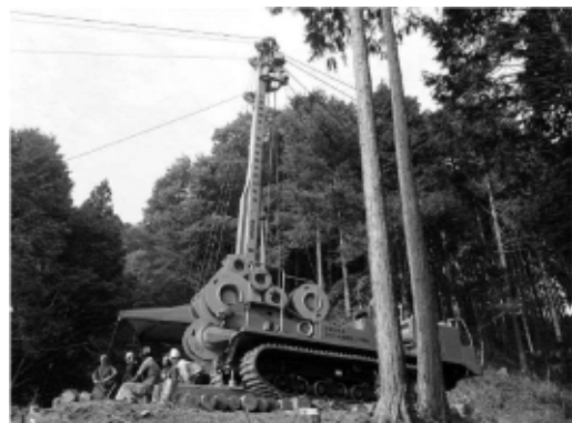
循環型林業で活躍するタワーヤーダ
