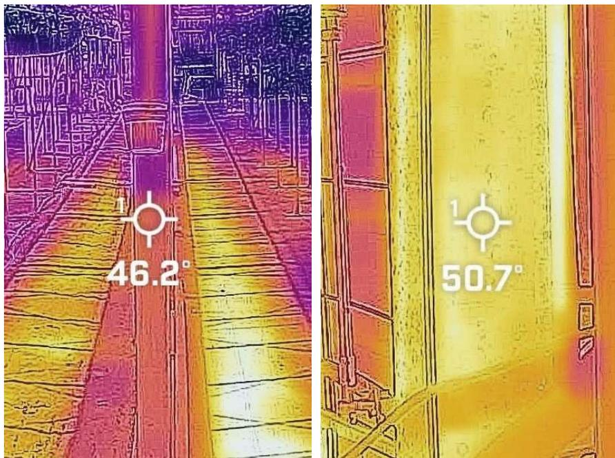
鉄骨の温度 左:外部遮光 右:内部遮光
