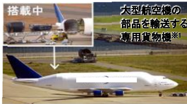
※1：専用貨物機 大型航空機の部品を運ぶための飛行機で世界に4機のみ存在（うち1機が中部国際空港から離発着） 大型航空機の35%は日本で生産されており、最終組み立て工場があるアメリカのエバレットまで運ぶ
